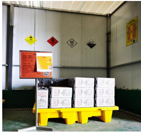
验收期间暂存的废铅蓄电池
